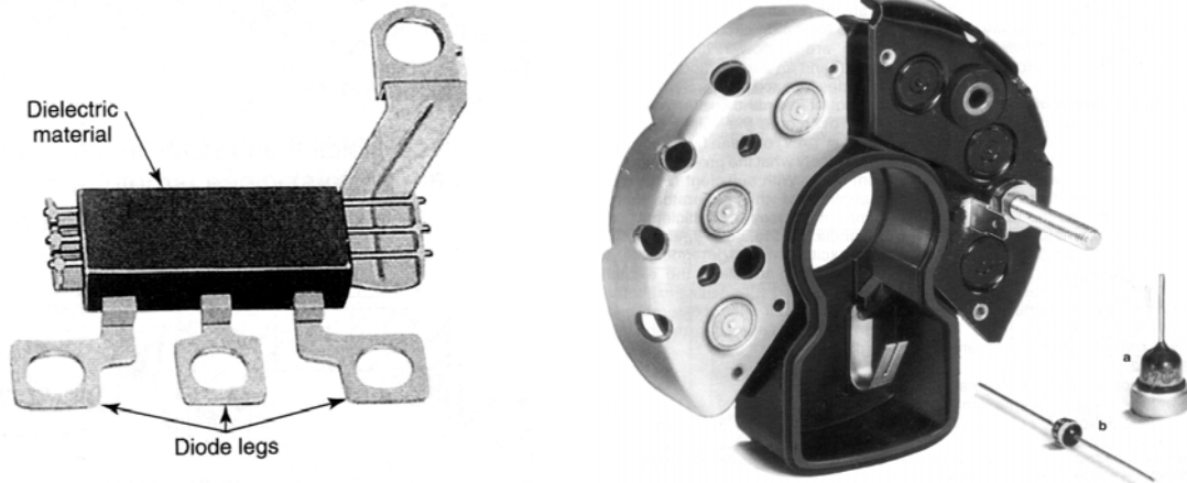
شكل (٣ - ٢٢): إلى اليمين: دايودات السليكون ولوح تثبيت الدايودات، إلى اليسار: الدايود الثلاثي (a: دايود قدرة (دايود تقويم)، b: دايود إثارة)
